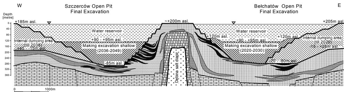
Figure 1. Final excavation at Bełchatów/Szczerców open pits (Szczepiński, 2000)
