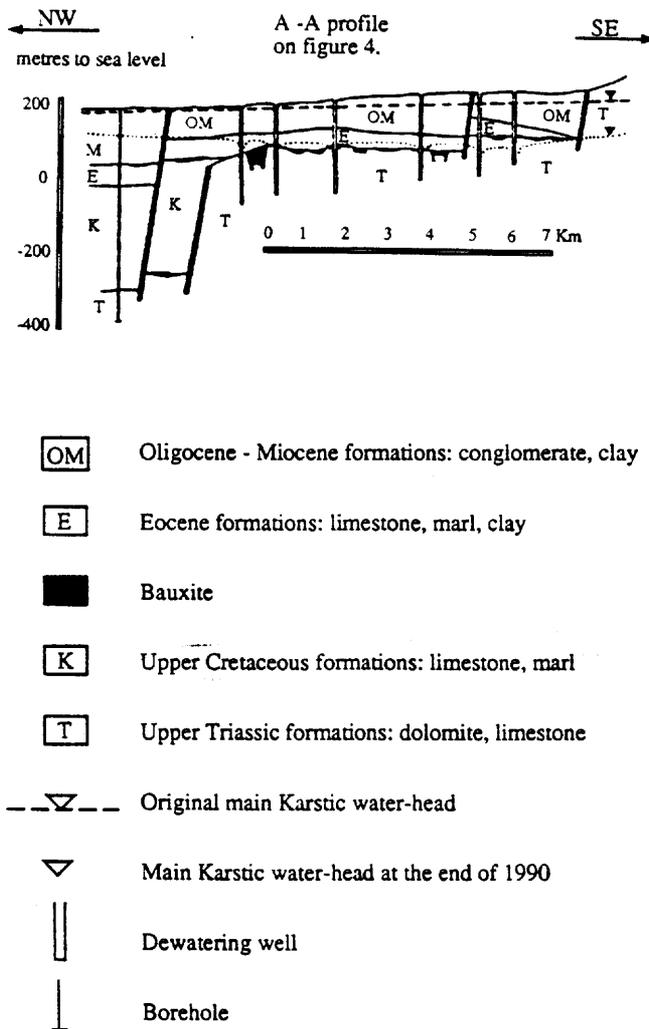
Fig. 5. Schematic section of Csabpuszta area.
