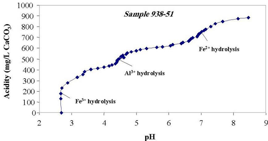
Fig. 4. Titration curve for AMD sample 938-51 (Cueva de la Mora mine).
