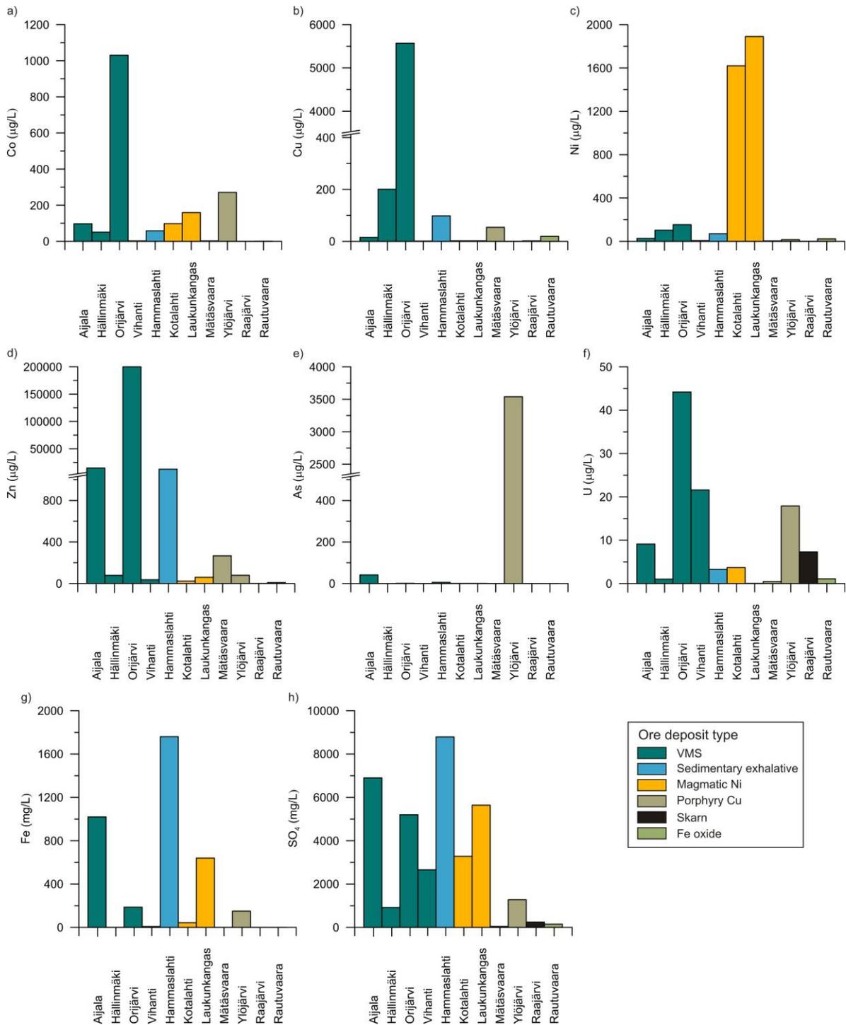
Figure 4 Concentrations of a) Co, b) Cu, c) Ni, d) Zn, e) As, f) U, g) Fe and h) SO<sub>4</sub> in the tailings seepage waters
