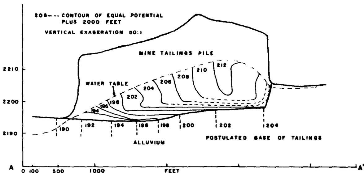
FIG. 6 POTENTIAL DISTRIBUTION WITHIN THE PAGE PILE AND ALLUVIUM ALONG EAST-WEST CROSS-SECTION A-A'
